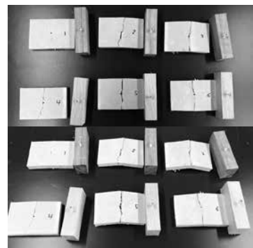
写真5 破壊された試験体
