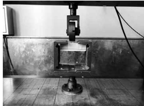
写真3 引抜耐力の試験 (木材試料+ビスL28)
