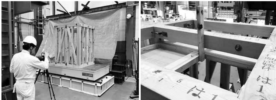
写真7 ユニット野縁の振動実験(その1)
