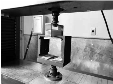
写真2 引抜耐力の試験 (石膏ボード+木材試料+ビスL28)
